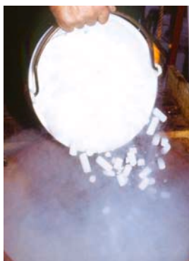
Utilisation du CO 2 sous forme de pellets pour inerte la vendange.
