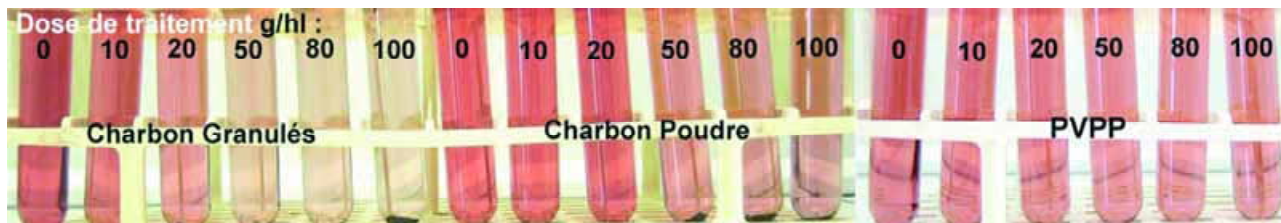
Figure 2. Traitement d'un vin rosé à 10, 20, 50, 80 et 100 g/hl avec 2 charbons et de la PVPP, en flacon
