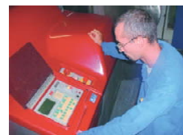
L'opérateur programme le cycle de pressurage.
